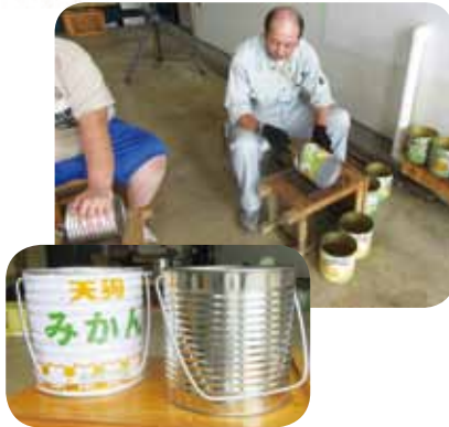
(上) 切り口の処理中。 (下) 完成したペンキ缶。 あえてプリントを残したのも。
